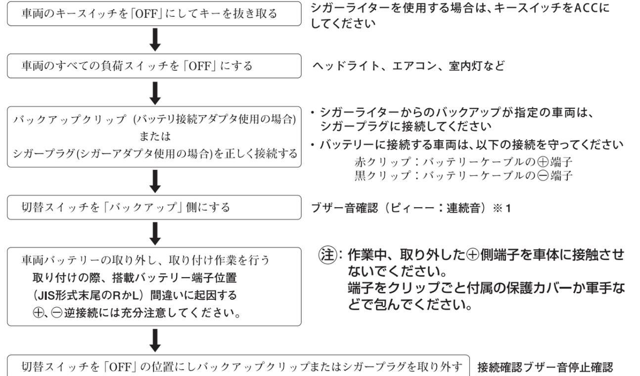
※1 ブザー音が断続音 (ピーー、ピーー) の場合はバックアップクリップまたはシガープラグの接続不良か逆接続または内蔵電池電圧の低下が考えられます。原因を取り除き作業を始めから行なってください。
