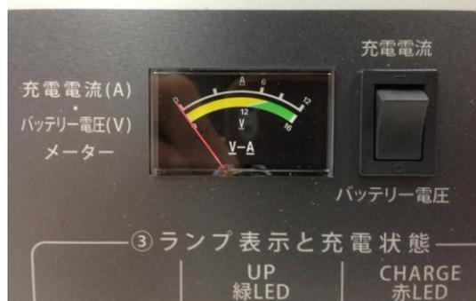
充電する前にメーター切替スイッチを「バッテリー電圧」側にし、バッテリーの電圧値を確認しましょう。緑ゾーンであれば充電不要、黄ゾーンであれば充電が必要になります。正確なバッテリー電圧・性能確認のためには、バッテリーテスターを使用しましょう。“アルプス計器製自動車用 CCA テスターSP1250BT”をおすすめします。
